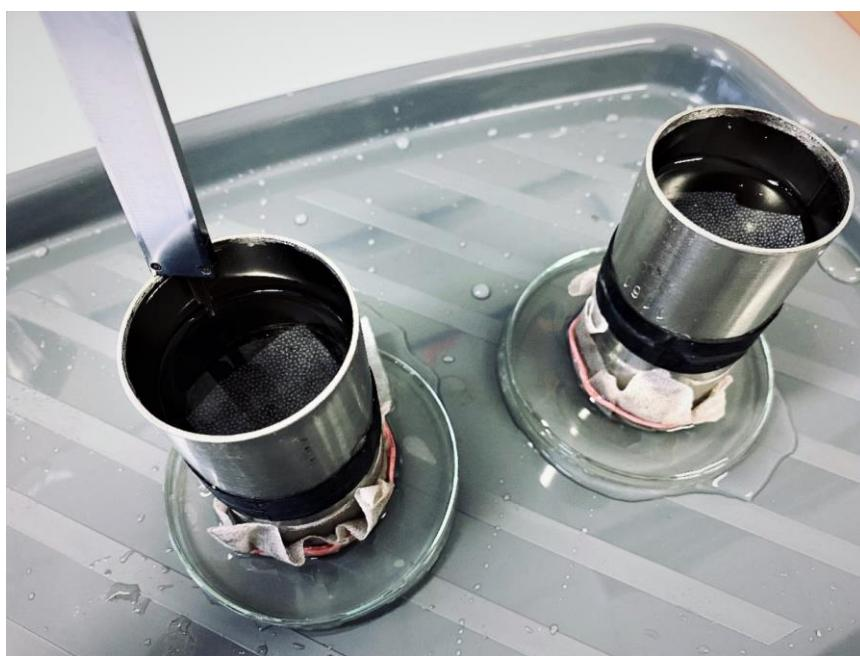
**Obr. 1. Laboratórne meranie nasýtenej hydraulickej vodivosti pôdy.**
