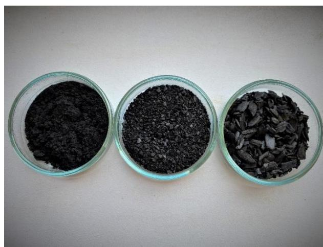
Obr. 5. Veľkosťné frakcie použitého biouhlia z ťava:  $<125\mu\text{m}$ ,  $125\mu\text{m} - 2\text{mm}$  a  $>2\text{mm}$ .
